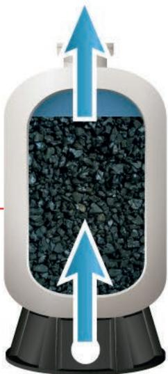
6. Retrolavar el filtro a una velocidad de **4-8 gpm/ft<sup>2</sup> (10-20 m/h)** hasta que el agua del retrolavado esté clara.
