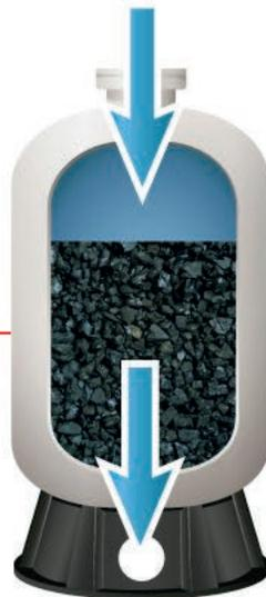
7. Realizar un enjuague de la cama con 1 gramo de **OXYDES-P®** por litro de material. Dejar reposar la cama con la solución de **OXYDES-P®** por un lapso de **30 minutos**. Realizar un enjuague rápido por **15 min.** (solo la primera vez).
