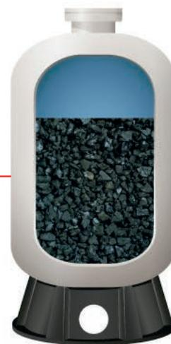
8. El sistema está listo para iniciar el servicio. Programar la duración del retrolavado regular entre **5 y 10 min** con una velocidad de **4-8gpm/ft<sup>2</sup> (10-20 m/h)** cada **48 a 72 horas** o cuando sea necesario para evitar la formación de canales en la cama.
